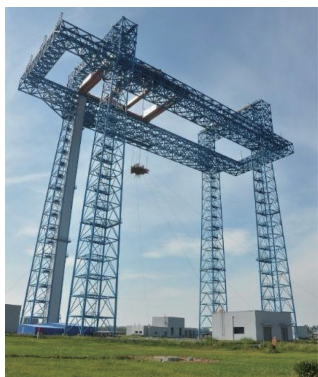
图 5 着陆器悬停避障及缓速下降试验设施
