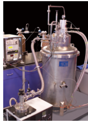
图6 佛罗里达太阳能研究中心液氢零蒸发试验系统 Fig. 6 Liquid hydrogen ZBO storage test system at FSEC
