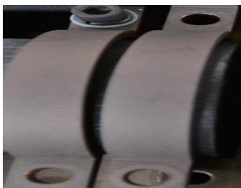
图4 预试验后紧固包带松脱现象
