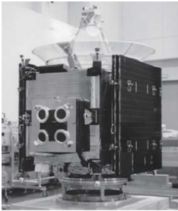
图2 推力器在航天器上的安装
