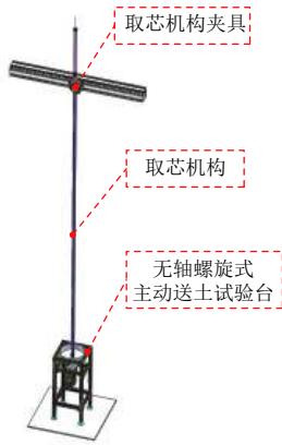
图2 月面采样主动送土试验台
