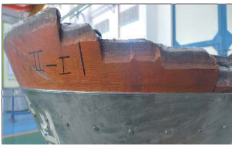
图2 喷管断口部位概貌
