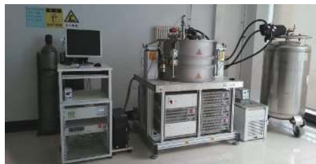
图9 耐驰GHP456导热系数测试设备
