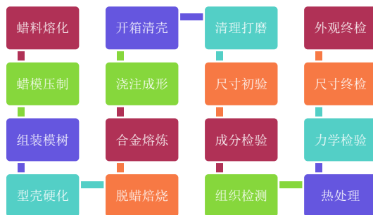
图14 栅格舵熔模精密铸造工艺流程
