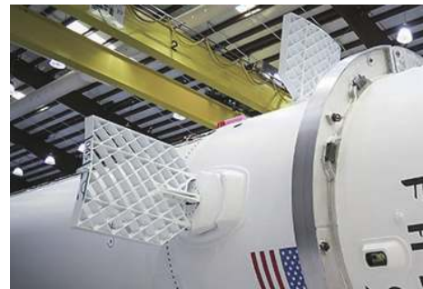
图1 Falcon 9火箭的栅格舵 Fig. 1 Grid fin of Falcon 9 rocket
