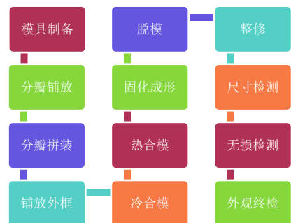
图 19 复合材料工艺流程 Fig. 19 Process flow of composite materials
