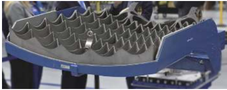
图 10 Falcon 9 Block5火箭的栅格舵 Fig. 10 Grid fin of Falcon 9 block5 rocket
