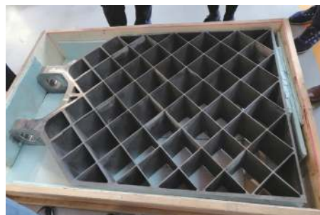
图15 CZ-2C Y37火箭的铸造钛合金栅格舵
