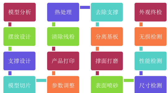
图 12 栅格舵SLM工艺流程 Fig. 12 Process flow of SLM
