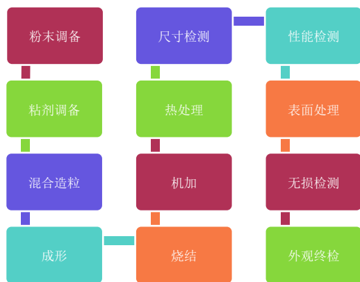
图13 粉末冶金工艺流程
