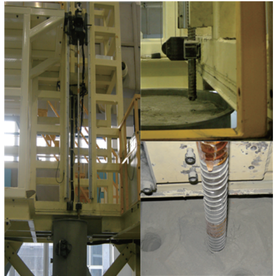
图 19 月壤钻进实验过程
