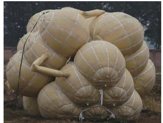
图1 火星全向缓冲气囊原理样机
