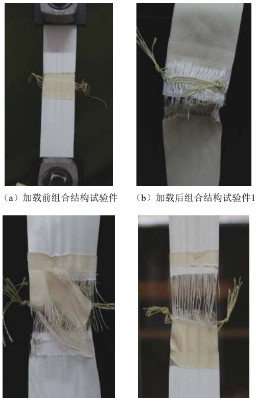
图 11 缝绉与热合组合形式试件强度试验现象
