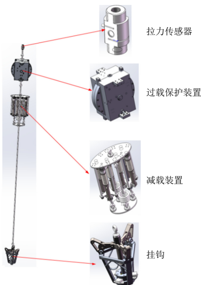
图11 空中回收智能挂取系统的组成
